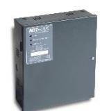
Station de porte pour contrôleurs ACT Pro 1500/1520/2000/4000 et 4200. Caractéristiques: Boîtier Plastic avec un ACT PRO 100 intégré, une alimentation 2A et place pour batteries back-up. Contrôle de présence de tension, tension de sortie et sabotage, Message de défaut via l'interface web. Poids: 2,450 kg, Température de fonctionnement: -10 à +50°C. Dimensions: 255 x 233 x 86 mm. Montage apparent / intérieur.
